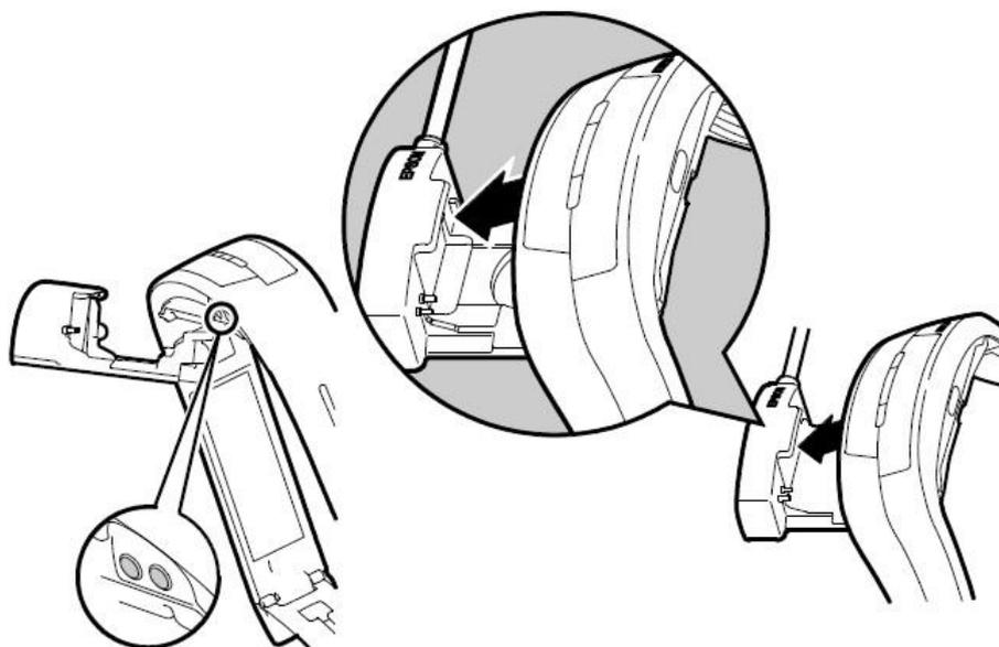
(2)、LED 燈號顯示螢幕朝上安裝，不可將底部朝上安裝以免造成感應器硬體故障。
