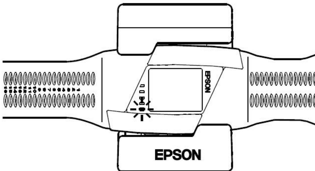
**註：如欲搭配於市售 USB 電源供應器充電時請務確認供應器電壓規格，PS-100 與 PS-500 僅支援於 AC 輸出電壓 5V 1.0A 的電源供應器，不可搭配於其他輸出電壓規格的電源供應器，以避免造成感應器無法正常充電或產品故障問題。**
