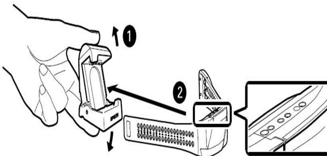
(2)、將充電底座接上電腦主機的 USB 埠或是 USB 型電源供應器進行充電運作，如 LED 燈號與感應器螢幕有顯示充電訊息即表示已重置感應器成功，可再取下並操作使用。
